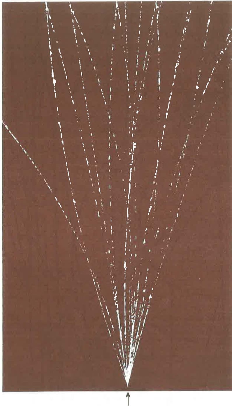
Erzeugung von Materie: Die Energie eines Teilchens (Pfeil unten am Bild) hat sich in achtzehn andere Teilchen verwandelt, von denen man die Spuren sieht. Dieses Bild wurde in einem Detektor gemacht, den man BLASENKAMMER nennt. Eine Blasenkammer ist mit einer Flüssigkeit gefüllt, und die Teilchen, die hindurchfliegen, hinterlassen eine Spur von ganz feinen Bläschen.
